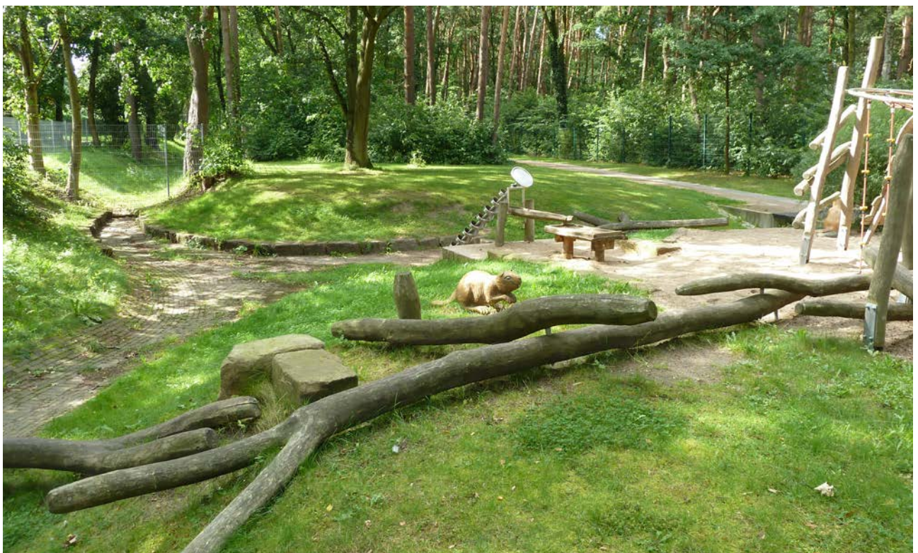
Bild 34: Mehrfachnutzung eines Spielplatzes in Hamburg Neugraben-Fischbek, der bei stärkeren Niederschlägen zu einem „Regenspielplatz“ wird
